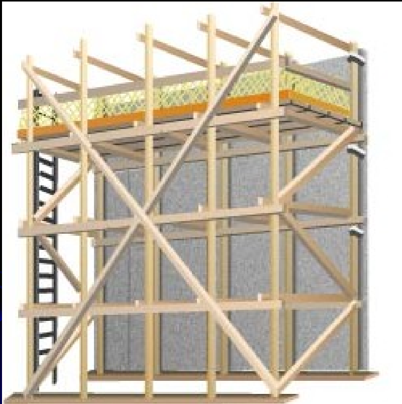
ξύλινες σκαλωσιές για ύψη < 10μ
